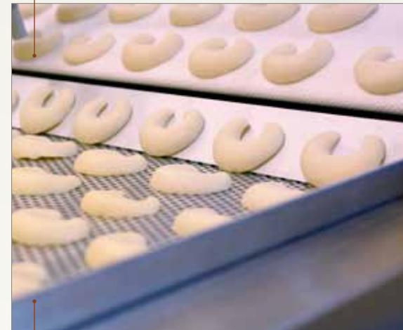
Bei der Belegung von Blechen mit höherem Rand mit Kleingebäck verhindert die Absetzlippe ein Herunterpurzeln der Gebäcke. Die Gebäcke rutschen über die Absetzlippe auf die Backbleche.
